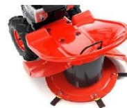
Kryt je navržen tak, aby umožňoval snadné sečení vysoké trávy; bezpečné sečení zajišťují postranní křivky.
